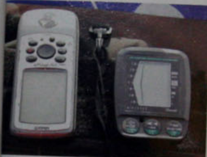
Paraglidista potřebuje ve vzduchu výškoměr, který ukazuje, jak rychle stoupáš nebo klesáš, a GPS navigaci, která udává polohu, rychlost a směr letu.
